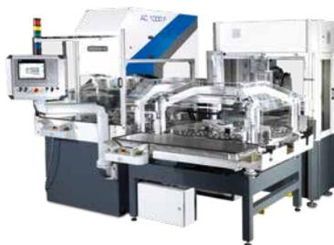
**TWIN LOADER UND ROBOTERZELLE**
